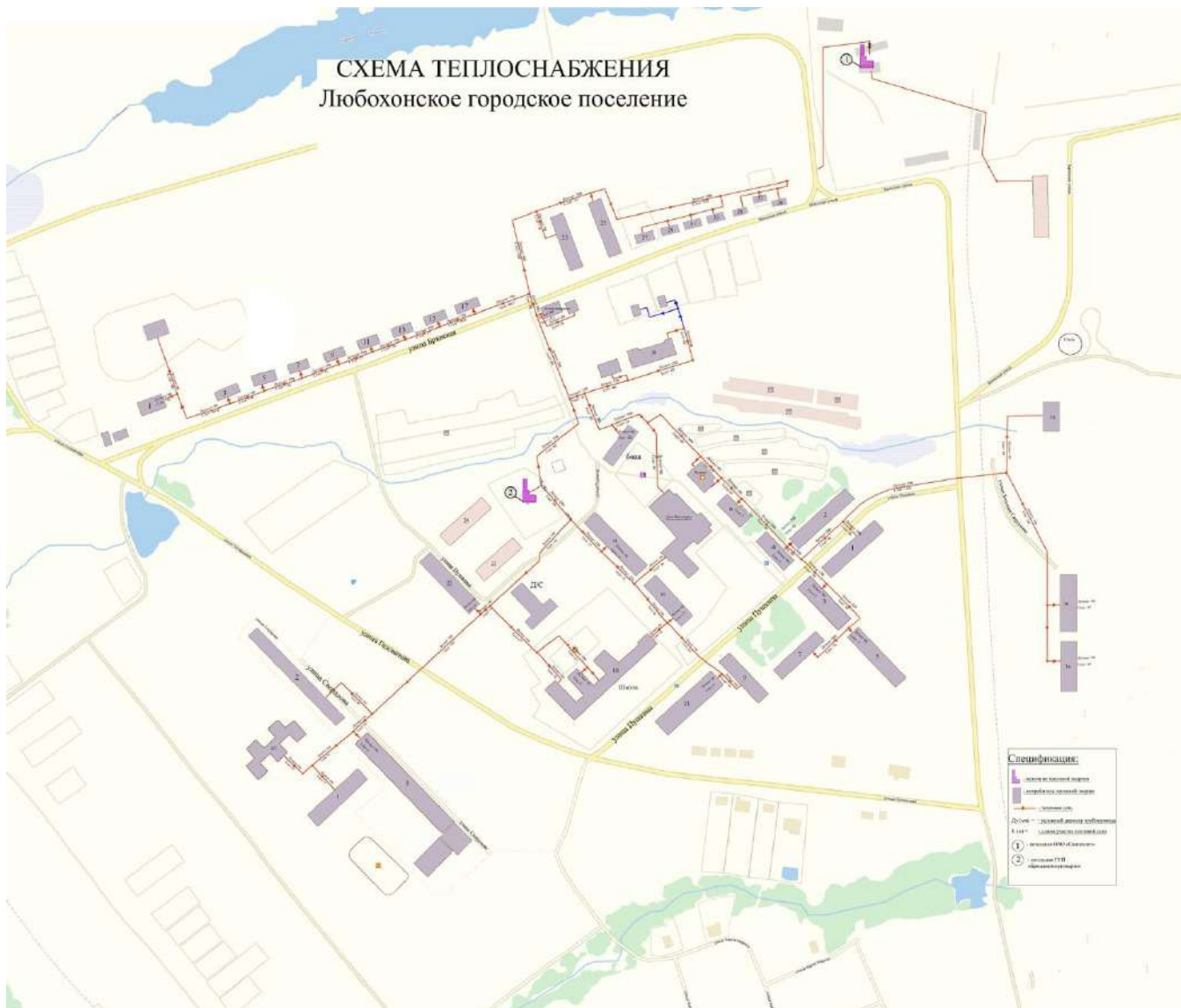
Рис.4 Схема тепловой сети системы отопления от котельной ГУП «Брянсккоммунэнерго»
